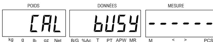
Si l'étalonnage est correct, le message CAL TEST DONE [TEST ÉTAL TERMINÉ] s'affiche quelques instants suivi de CLEAR PAN THEN PRESS ENTER [DÉGAGER PORTÉE ET APPUYER SUR ENTRÉE].
