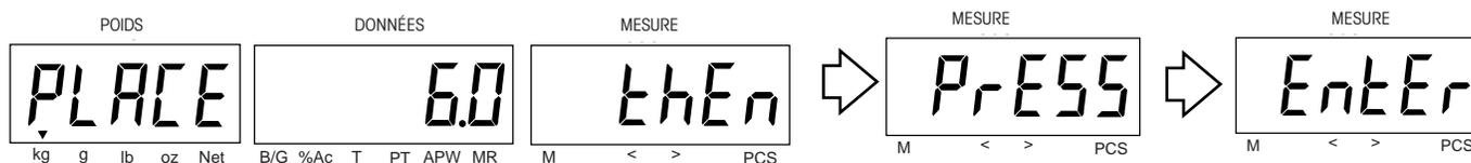
Placez la masse de calibration indiquée sur le plateau. Appuyez sur **Enter**. L'exemple montre une balance de 6 kg et une masse de 6 kg pour la première entrée de linéarité.
