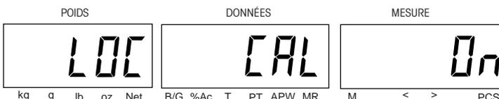
LOC SETUP - Lorsqu'il est réglé à ON, le sous-menu SETUP est verrouillé. Sélectionnez ON ou OFF.
