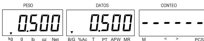
Pulse la tecla **TARE**. Se calcula la tara el recipiente, el peso neto se muestra en la pantalla de PESO y la tara en la pantalla de DATOS.
