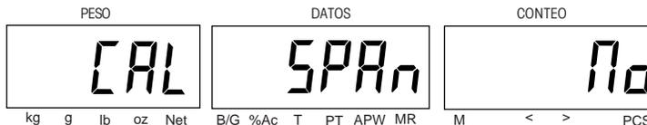
Pulse la tecla **M-** para cambiar a YES, después pulse la tecla **Enter**.
