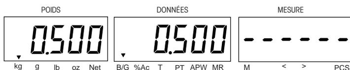
Appuyez sur la touche **TARE**. Le récipient est pesé, le poids net est indiqué sous WEIGHT et la tare figure sous DATA.
