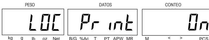
LOC COUNT – Cuando se fija en ON, bloquea el submenú COUNT (conteo). Seleccione ON u OFF.
