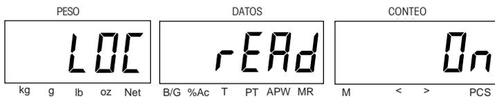
LOC PRINT – Cuando se fija en ON, bloquea el submenú PRINT (impresión). Seleccione ON u OFF.
