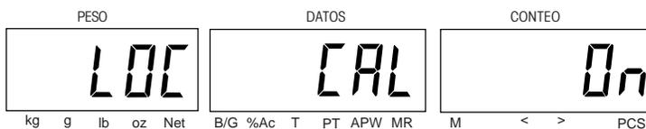
LOC SETUP – Cuando se fija en ON, bloquea el submenú SETUP (configuración). Seleccione ON u OFF.
