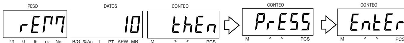
Retire las 10 piezas según se indica, o use el teclado para cambiar el número de piezas que hay que retirar y después pulse la tecla **Enter**.
