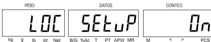
LOC READ – Cuando se fija en ON, bloquea el submenú READ (lectura). Seleccione ON u OFF.
