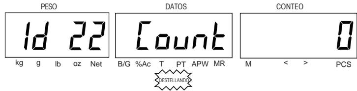
Introduzca el conteo deseado usando el teclado numérico. La muestra es de 250 piezas. Pulse la tecla **Enter** para aceptar.
