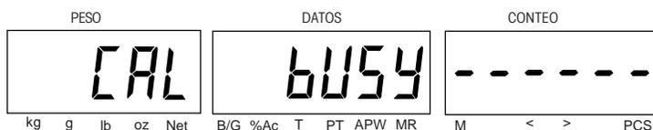
Si se hizo bien la calibración, se muestra momentáneamente SPAN TEST DONE seguido de CLEAR PAN THEN PRESS ENTER.
