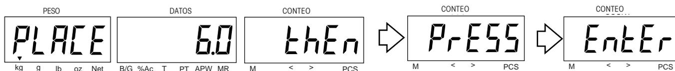
Ponga la pesa de calibración indicada en el platillo. Pulse la tecla **Enter**. La ilustración de muestra indica una balanza de 6 kg usando una pesa de 6 kg.
