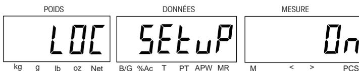
LOC READ - Lorsqu'il est réglé à ON, le sous-menu READ est verrouillé. Sélectionnez ON ou OFF.
