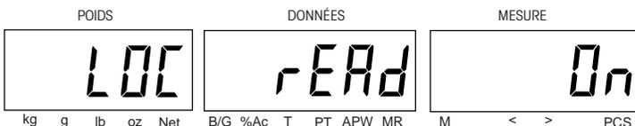
LOC PRINT - Lorsqu'il est réglé à ON, le sous-menu PRINT est verrouillé. Sélectionnez ON ou OFF.
