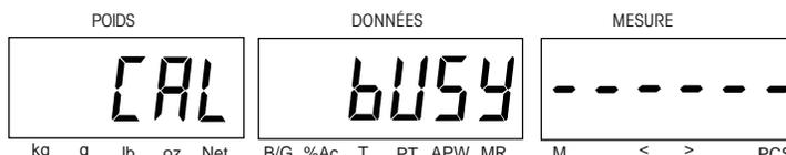
Si l'étalonnage est correct, le message SPAN TEST DONE [TEST PORTÉE TERMINÉ] s'affiche quelques instants suivi de CLEAR PAN THEN PRESS ENTER [DÉGAGER PLATEAU ET APPUYER SUR ENTRÉE].
